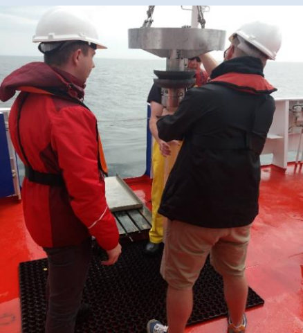
Pobieranie rdzenia sondą Rumohr-Lot i wyciskanie osadu
