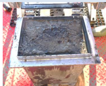
Pobieranie rdzenia sondą Rumohr-Lot i wyciskanie osadu
