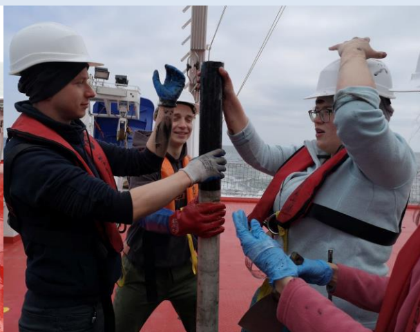
Pobieranie rdzenia sondą Rumohr-Lot i wyciskanie osadu
