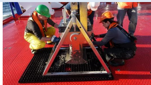
Pobieranie rdzenia sondą Rumohr-Lot i wyciskanie osadu
